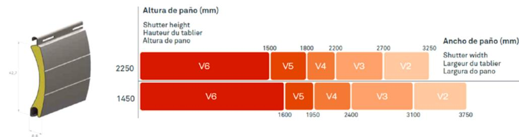
Conforme a los resultados de los ensayos de viento facilitados por el fabricante según la norma EN 13659, y teniendo en cuenta que la configuración de la instalación debe ser la misma que la utilizada para la realización del Ensayo de Tipo:
