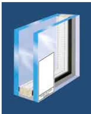
se producen fenómenos de convección dentro de la misma (en torno a los 17 mm).
