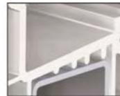
Eurodur tiene **dos cámaras de aire más una gran cámara central** donde se aloja el refuerzo de acero. La hoja puede ser de **58 mm** (retranqueada) o de **74 mm** (enrasada). Esta profundidad de perfiles permite alojar vidrios de cualquier espesor, desde 3 hasta 47 mm (68 mm con prolongador).
